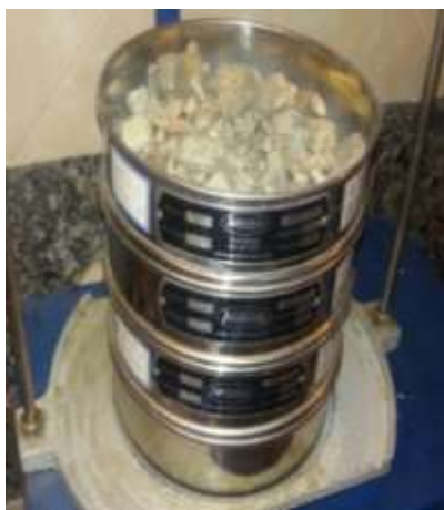
شکل ۳- الک‌های مورد استفاده جهت دانه‌بندی
