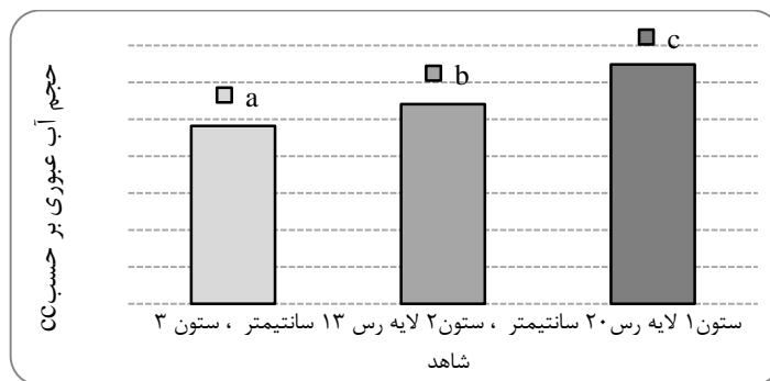
شکل ۵- نسبت حجم خروجی آب در ستون های با و بدون لایه رسی تغذیه شده با غلظت ۲۰ میلی اکی والان نمک
